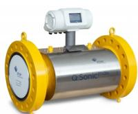
Ультразвуковые расходомеры газа серии Q.Sonic предназначены для измерений объемного расхода и объема однокомпонентных и многокомпонентных газов, находящихся в однофазном состоянии. Использование многолучевых схем (6 или 8 лучей) позволяет выявить и учесть все асимметрии профиля потока. Данные конфигурации обеспечивают максимальную точность измерений в сочетании с высокой надежностью.
