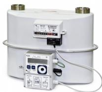
Комплексы для измерения количества газа СГ-ТК-Д с температурным корректором объема газа ТС220 предназначены для измерения объема неагрессивного сухого газа, приведенного к стандартным условиям путем измерения объема газа при рабочих условиях счетчиками диафрагменными (ВК) и автоматической электронной коррекции по измеренному значению температуры газа и подстановочному значению давления газа. Возможно несколько вариантов монтажа корректора и мест установки датчиков температуры.
