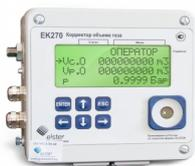
Корректоры объема газа предназначены для измерения объема неагрессивного сухого природного или попутно-нефтяного газа, приведенного к стандартным условиям путем измерения объема газа при рабочих условиях счетчиками газа турбинными (TRZ, СГ), ротационными (RABO, RVG) и автоматической электронной коррекции по измеренным значениям температуры и давления газа и вычисленному значению коэффициента сжимаемости. Корректоры имеют архивы и могут передавать данные в системы телеметрии.
